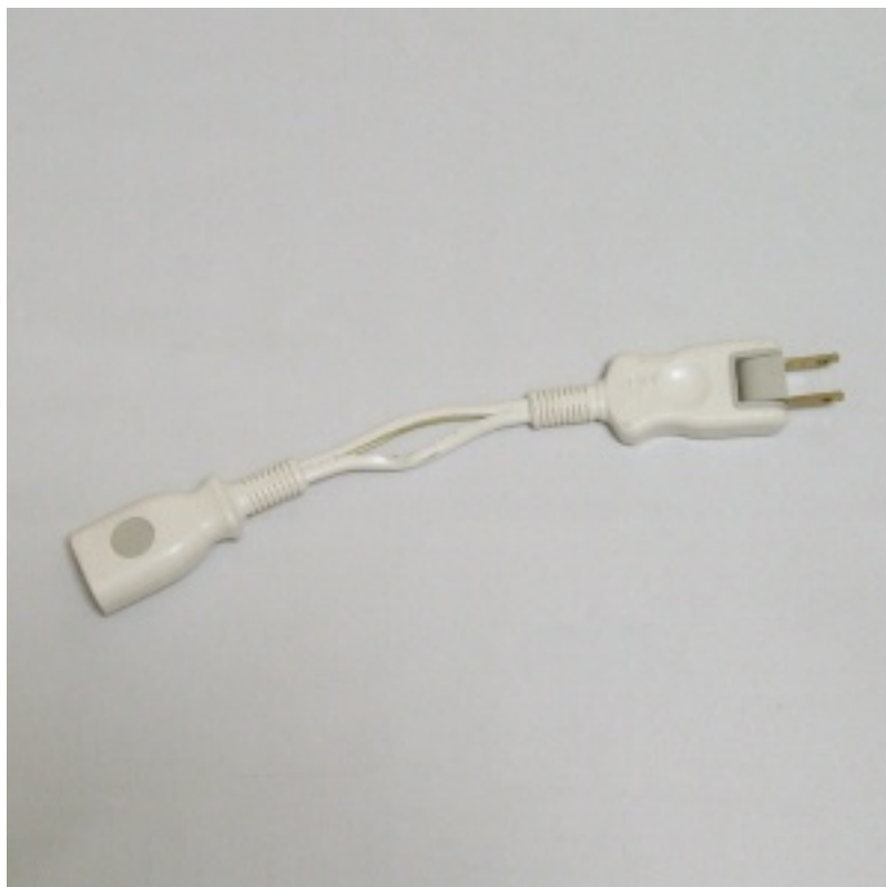
【図： 自作したラインセパレータ(延長ケーブルを中央から裂くだけ)】
